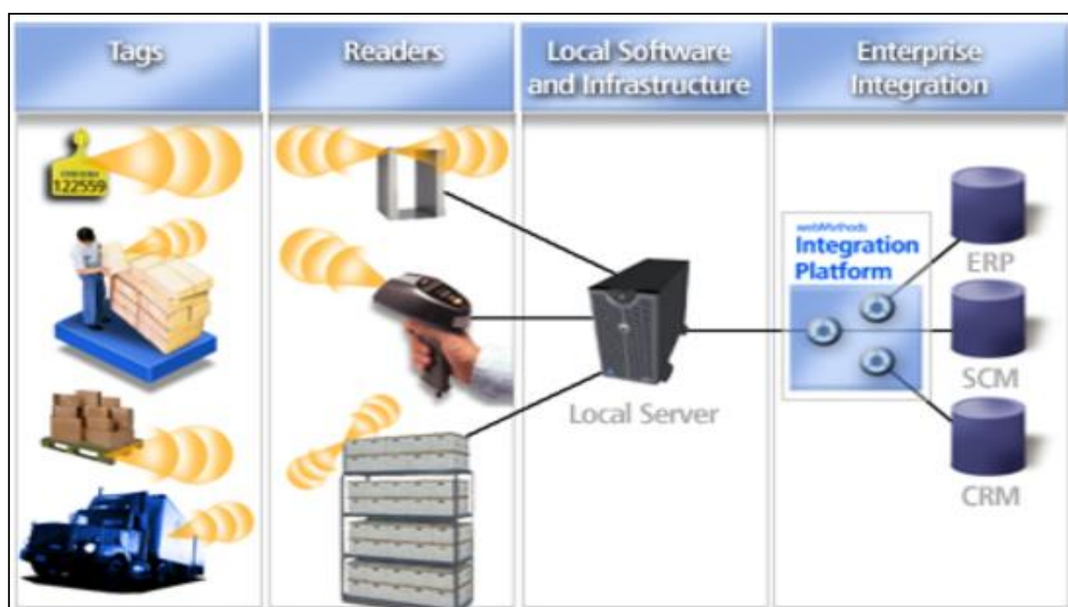
FIGURA 9 – Funcionamento do RFID
